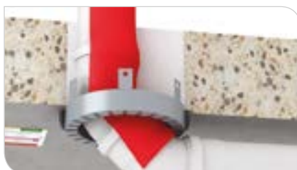
Kniestück bzw. Abzweige (ggf. Haltetaschen eingemörtelt) bis Manschettengröße 160 mm
