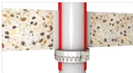
schallgedämmte Abwasserrohre mit PE-Schallschutzschlauch
